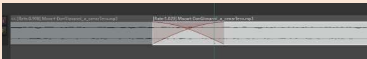
Slika 36 - Po povečavi se oba dela združita z vzajemnim izginjanjem, kar je na sliki vidno z rdečimi črtami.
