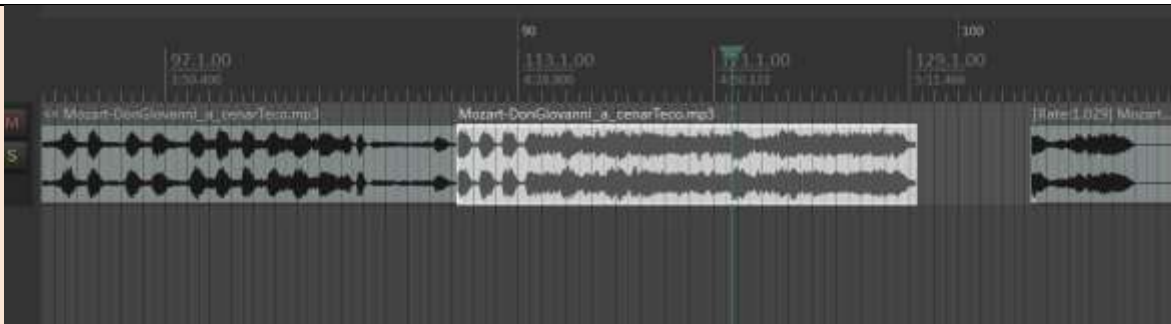
Figura 34 - Cursorul este poziționat pe pistă, pregătit pentru separarea cadenței pe care dorim să o încetinim.
