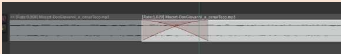
Figura 36 - Dopo lo zoom, le due parti vengono fuse insieme con una dissolvenza reciproca, visibile nelle linee rosse della figura.
